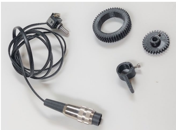
Abbildung 2: Rotationsencoder und 3D-Komponenten.
