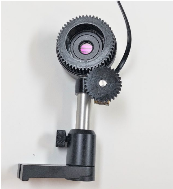
Abbildung 3: fertig montiertes Getriebe für das Auslesen der Drehwinkel.
