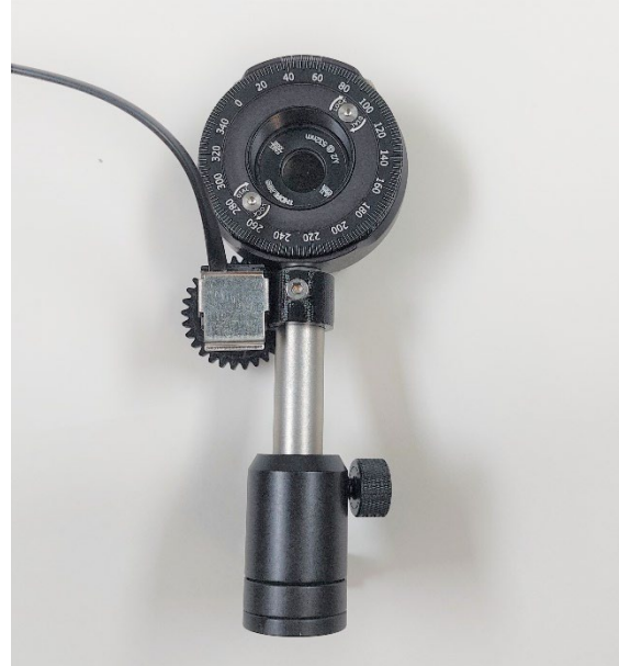
Abbildung 3: fertig montiertes Getriebe für das Auslesen der Drehwinkel.
